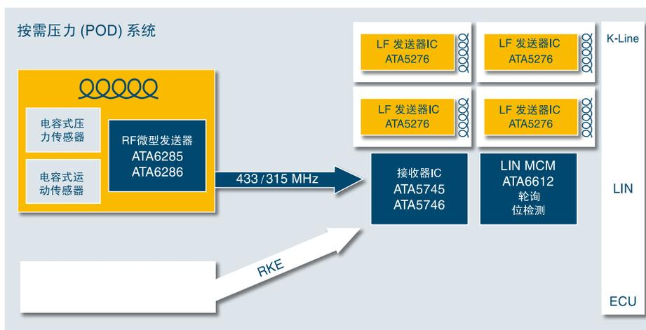
系统是一种主/从系统。除了直接式系统之外, 它还包含一个 的内置通道, 用于在预先定义的工作周期中唤醒传感器模块。当通过对存储器重编程来替换轮胎时, 这类系统可显著提高车轮初始
