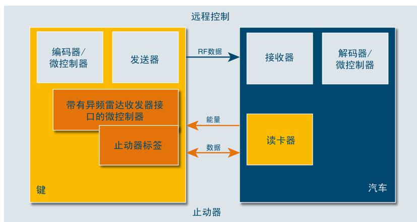
单向RF频段无线通讯用于遥控开关车门功能。防盗锁止系统 (Immobilizer System) 内建有采用AUT64加密算法可实现双向LF频段无线通讯认证。
