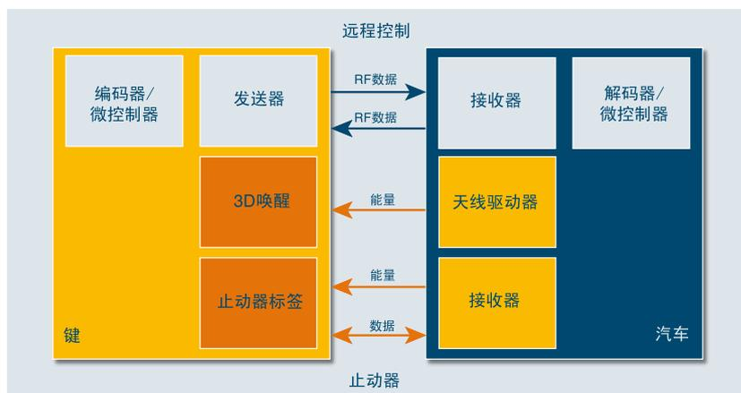
双向RF频段通讯用于无钥匙自动识别车门锁控系统 (PEG) 中，确保门控更安全；LF频段通讯实现PEG系统中的唤醒功能，以及用于防盗锁止功能和启动RF频段通信功能。
